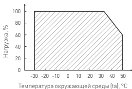
Рис. 1. Максимальная допустимая нагрузка, % от мощности источника.
